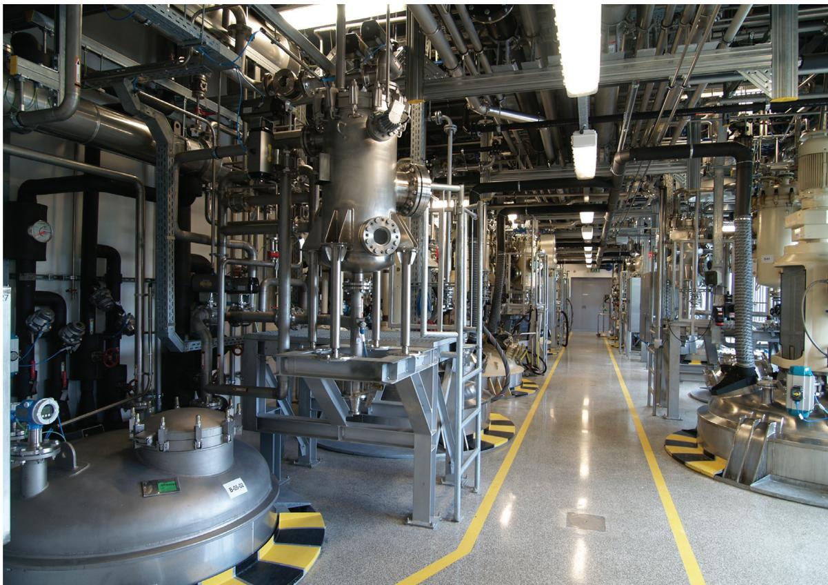
Для получения различного вида готовой продукции в химической промышленности используется большое количество специализированного оборудования (реакторное, теплообменное, оборудование для грануляции и получения чешуек готового продукта и т.д.)
